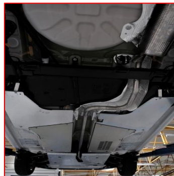
Protections sous moteur et sous caisse
