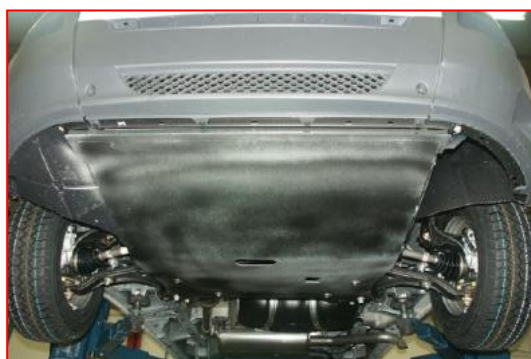
Protections sous moteur et sous caisse
